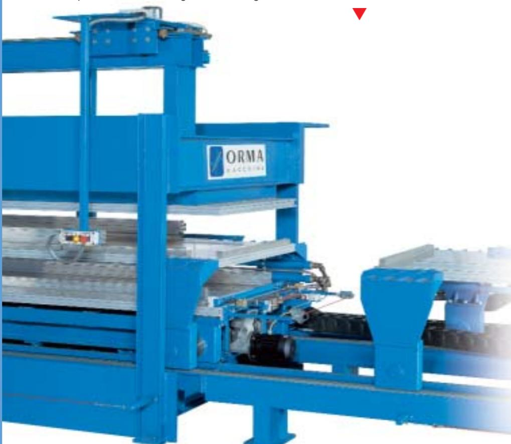
Particolare del sistema automatico di contenimento laterale; si puo' apprezzare l'apparecchiatura pneumatica per la movimentazione di apertura e di chiusura dei profili di alluminio. Questo dispositivo permette una rapida preparazione del pannello da schiumare e semplifica le operazioni di scarico del pannello gia' schiumato.
