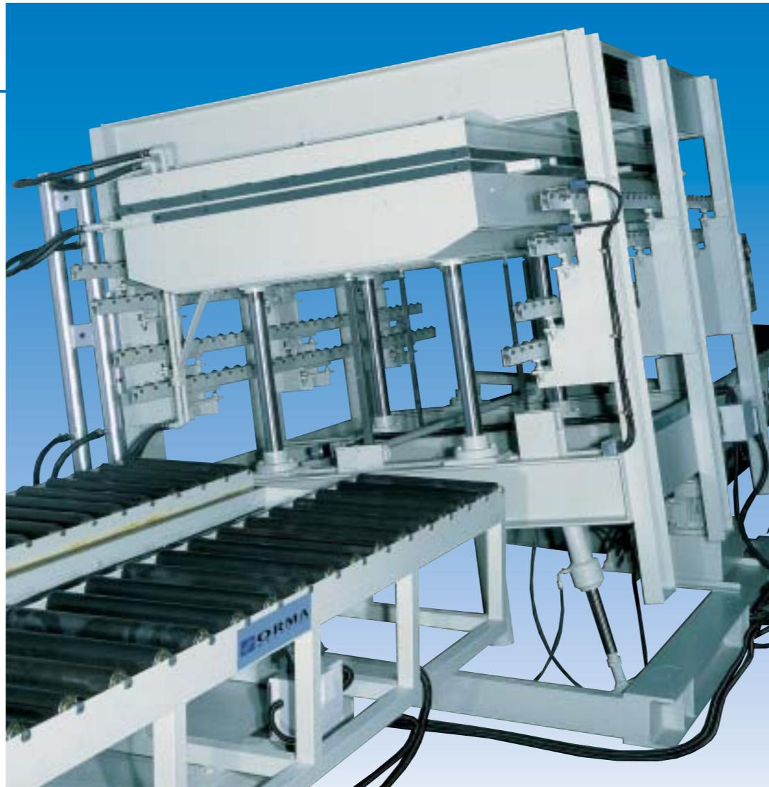
Dettaglio del sistema a estrattore/spintore dei vassoi. Si possono notare i vassoi in alluminio dotati di "anelli" di aggancio. I vassoi scorrono su dei rulli liberi sulla piattaforma e su vie a rotelle per guiderli all'interno della pressa. Il sistema garantisce precisione e stabilità durante le fasi di traslazione.
