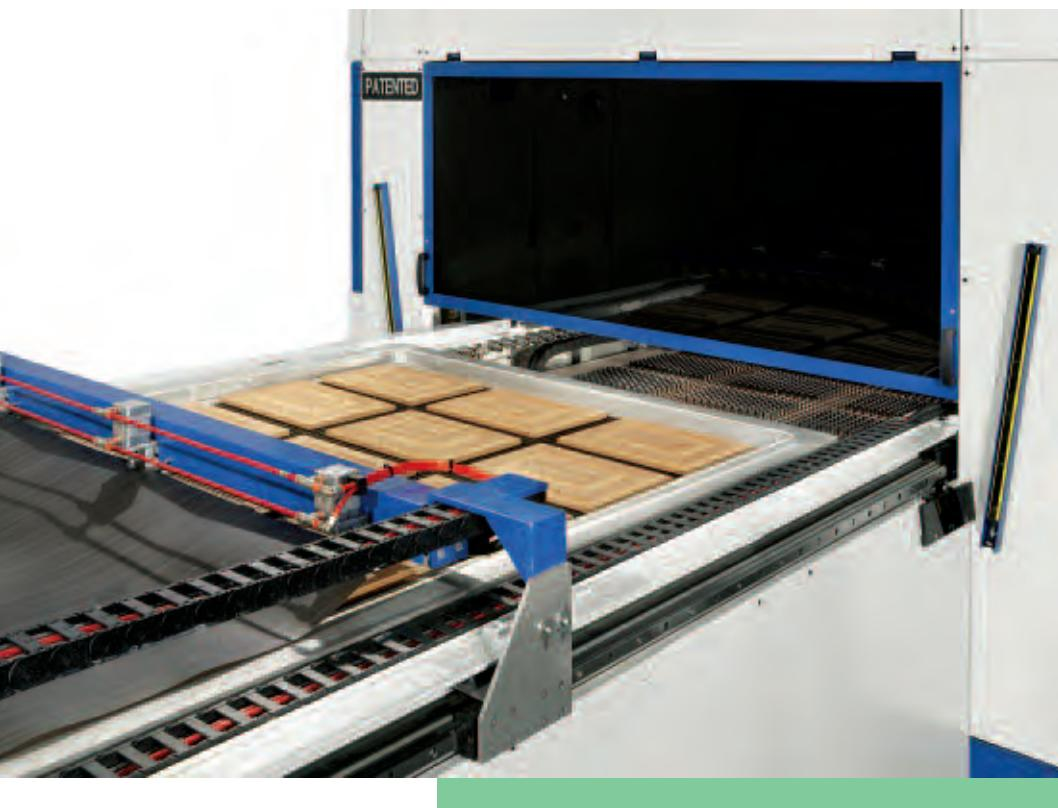
Gruppo di carico con trascinamento del PVC e scansione in simultanea del materiale da rivestire per il conseguente settaggio in automatico del PIN SYSTEM in presa
